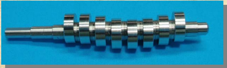
SUS304 8連のカムを旋盤にて1チャック加工
