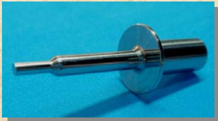
SUM24L 焼き入れ後Ra0.4・Ra1.6に加工 かつ、Ra0.4部を真円度0.3μmに切削加工
