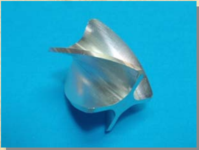
A5056 複合旋盤によるスクリュー加工
